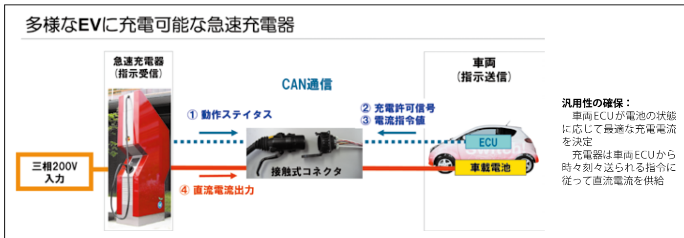
図－1 急速充電器のしくみ
